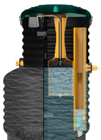
Требуемый уровень воды в станции после монтажа
